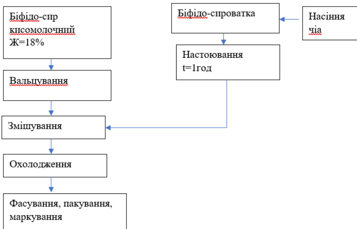
Рис. 1. Принципова технологічна схема переробки молока у комбіновані біфідо-десерти
