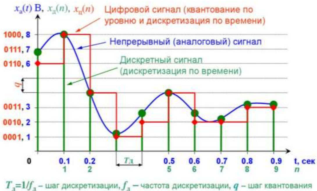
Рисунок 10 – Принцип роботи АЦП
