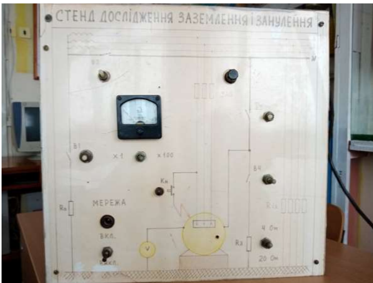
Фото 2 - Лабораторна установка « Дослідження захисного заземлення та занулення »
