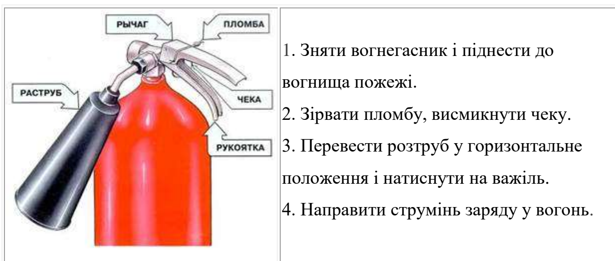
Рисунок 8 - Порядок приведення в дію вогнегасника ВВ-2
