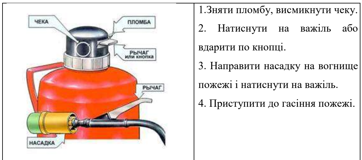
Рисунок 6 - Порядок приведения в дію вогнегасника ВПП-10
