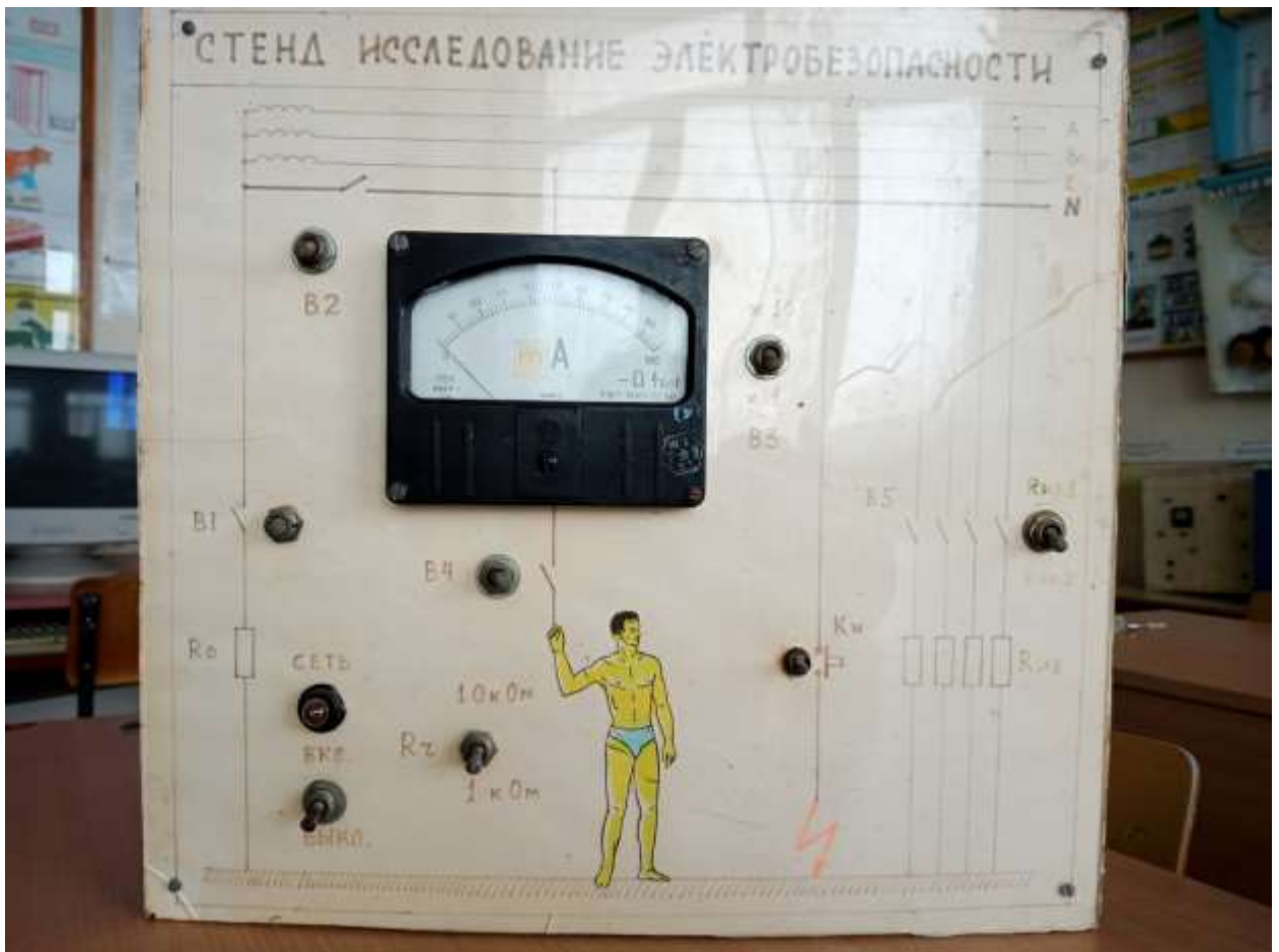
Фото 1 – Лабораторна установка «Дослідження електробезпеки»
