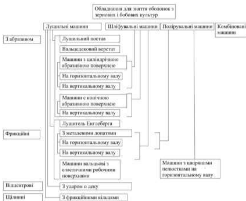
Рисунок - 1. Класифікація луцильних, шліфувальних і полірувальних машин.
