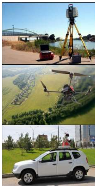
Рис. 1 Види лазерного 3D сканування (1 Наземне лазерне сканування, 2 Повітряне лазерне сканування, 3 Мобільне лазерне сканування)
