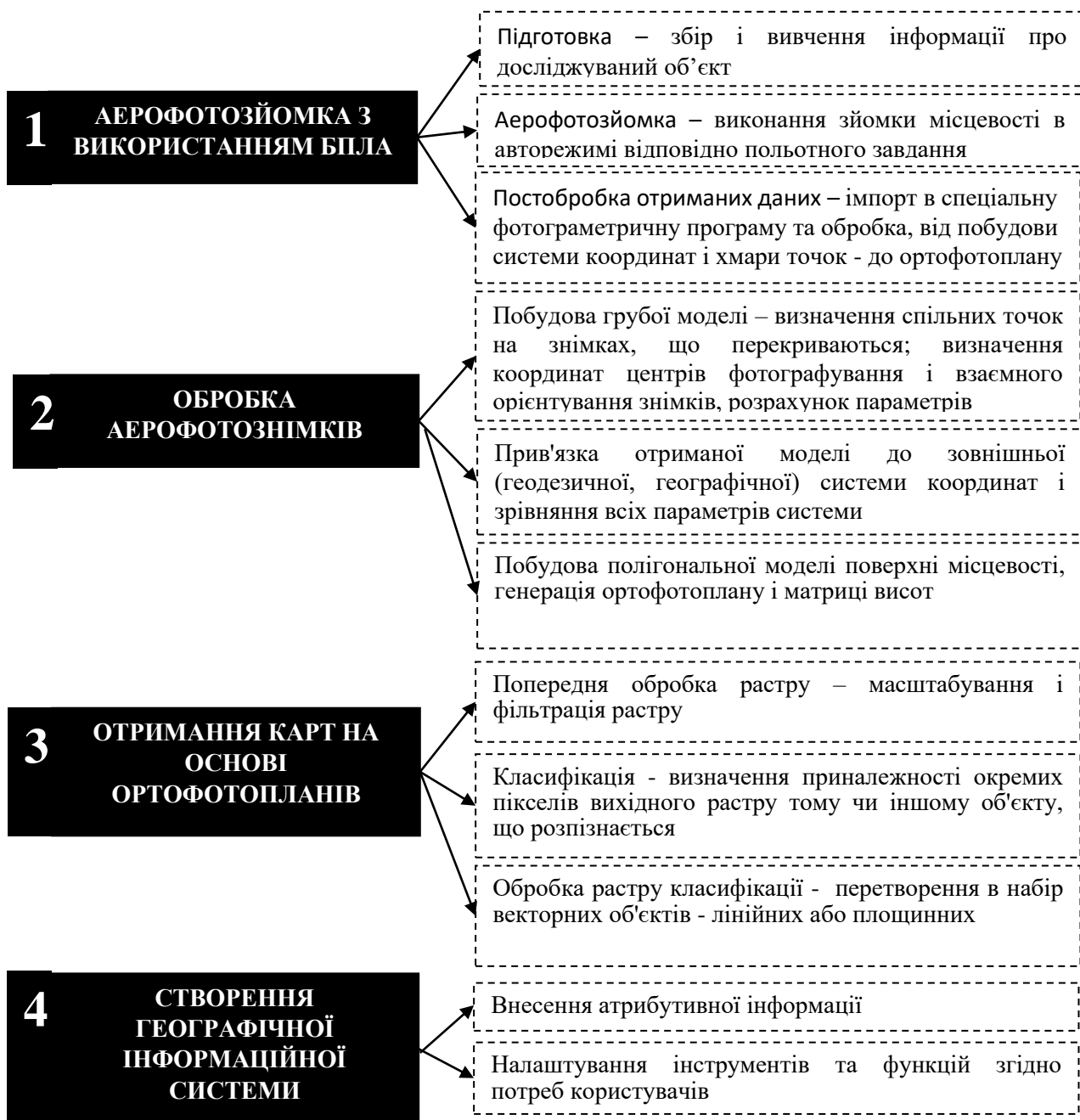
Рис.1. Узагальнений алгоритм створення ГІС на підставі даних, отриманих з використанням БПЛА
