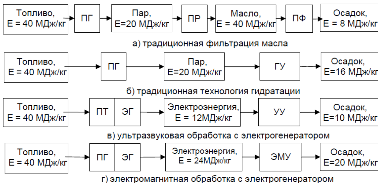
Рис. 3. Конверсия энергии в технологиях очистки масла.
