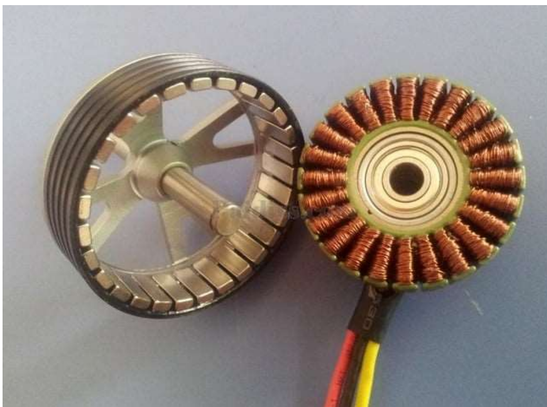
Рисунок 4.27 - Конструкція БДПС з зовнішнім ротором
