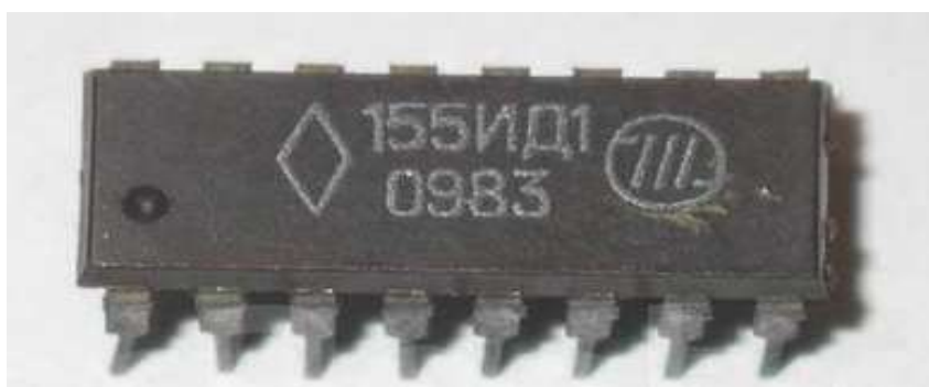
Рисунок 10.29 - Дешифратор двійково-десятькового коду в десятиковий
