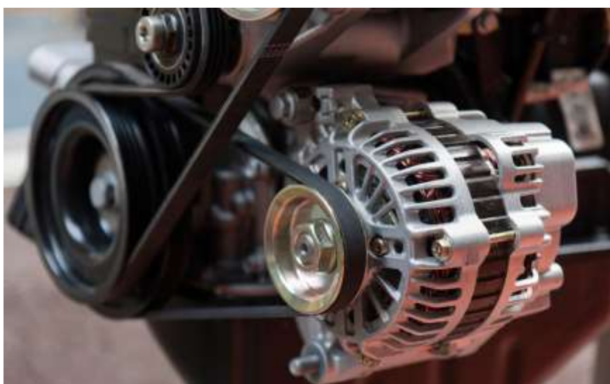
Рисунок 6.18 - Місце автомобільного генератора в машині
