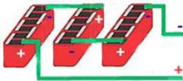
Рисунок 1.9 - Послідовне з'єднання акумуляторів
