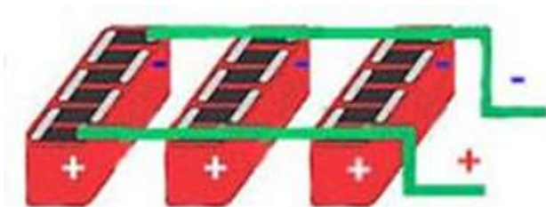
Рисунок 1.11 - Паралельне з'єднання акумуляторів
