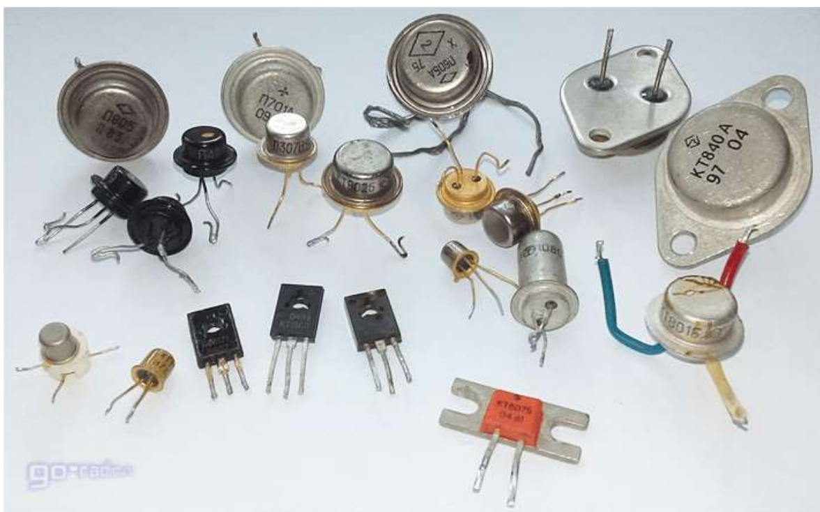
Рисунок 9.4 – Види біполярних транзисторів
