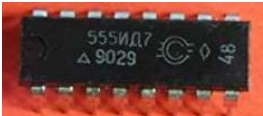
Рисунок 10.33 - Дешифратор двійково-десятькового коду в код семисегментного індикатора
