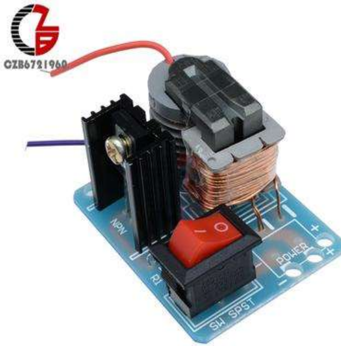
Рисунок 8.17 - Інверторний генератор високої напруги запалювання
