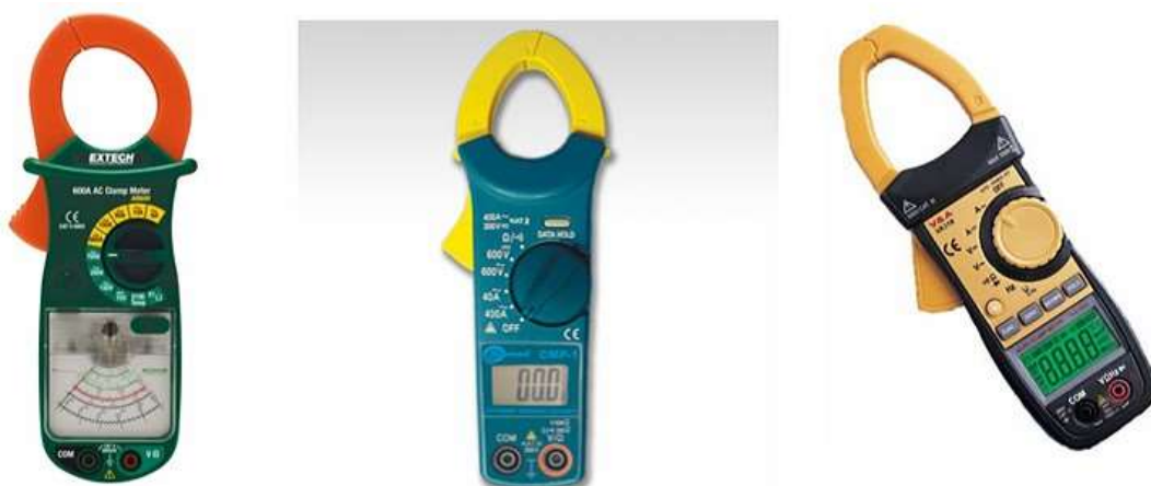
Рисунок 5.16 - Струмовимірювальні кліщі аналогові Extech AM600 (а), цифрові SMP-1 (б), McBrain VA318 (в)
