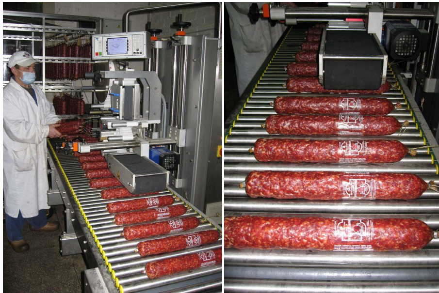
Рис. 31. Після повного циклу виготовлення, кожен батон надходить на маркіровочну машину, де отримує етикетку з назвою
