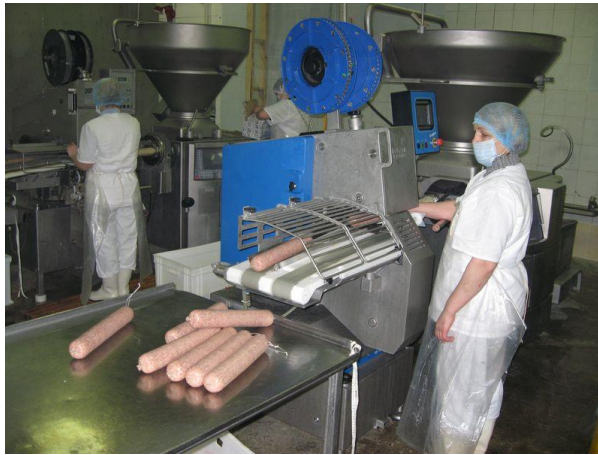
Рис. 25. Наповнення оболонок автоматичними шприцами наповнювачами HANDTMANN VF 628 в тандемі з кліпсаторами POLY-CLIP, ALPINA
