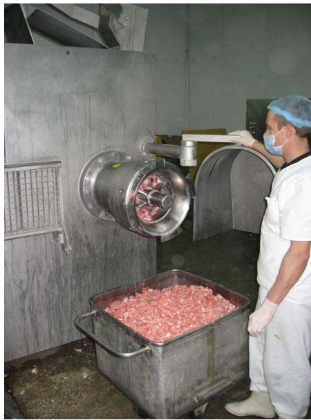
Рис. 17. Подрібнювач морожених блоків. Велетенська м'ясорубка компанії «Seydelmann»
