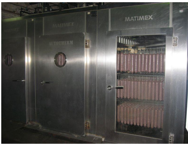
Рис. 28. Кліматичні камери AUTOTHERM, де ковбаса знаходиться протягом 5 діб. За цей час вона звільняється від надлишкової вологи, буде коптитися в зоні безпечного диму
