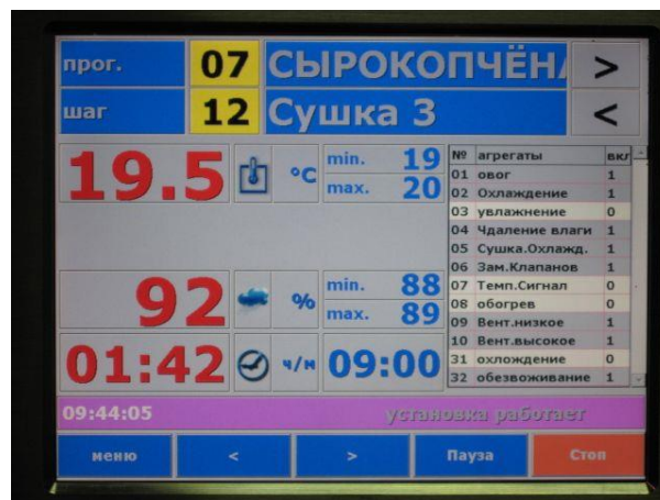
Рис. 29. Усі процеси у кліматичній камері відслідковуються за допомогою комп'ютеру, де закладена точна почасова програма з усіма режимами обробки (вологість, рух повітря, кількість диму, охолодження, підігрівання та ін.)
