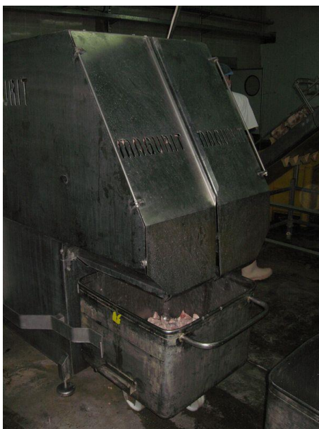
Рис. 17. Подрібнювач морожених блоків. Велетенська м'ясорубка компанії «Seydelmann»
