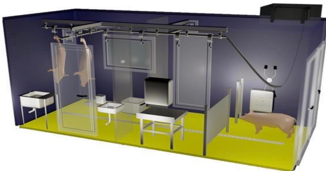
Рис. 3.2. Схема забійного мобільного цеху
