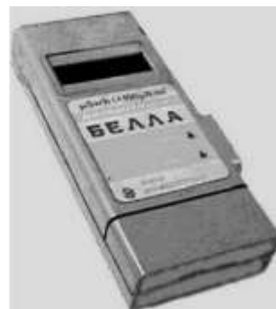
Рис. 5.15. Індикатор зовнішнього гамма-випромінювання «БЕЛЛА»
