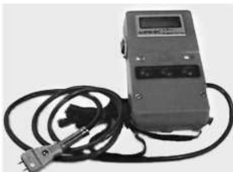
Рис. 5.14. Дозиметр-радіометр побутовий АНРИ-01 «Сосна»
