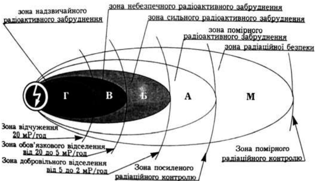
Рис. 6.2. Характеристика зон радіоактивного забруднення місцевості при аварії на ЧАЕС
