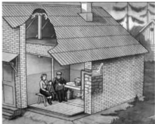
Рис. 8.12. Пристосування наземного будинку під захисну споруду
