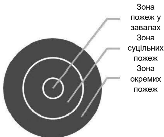
Рис. 5.1. Характеристика зон пожеж в осередку ядерного ураження
