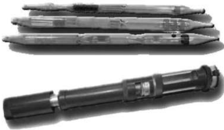
Рис. 5.22б. Індикаторні трубки та насос приладу ВПХР
