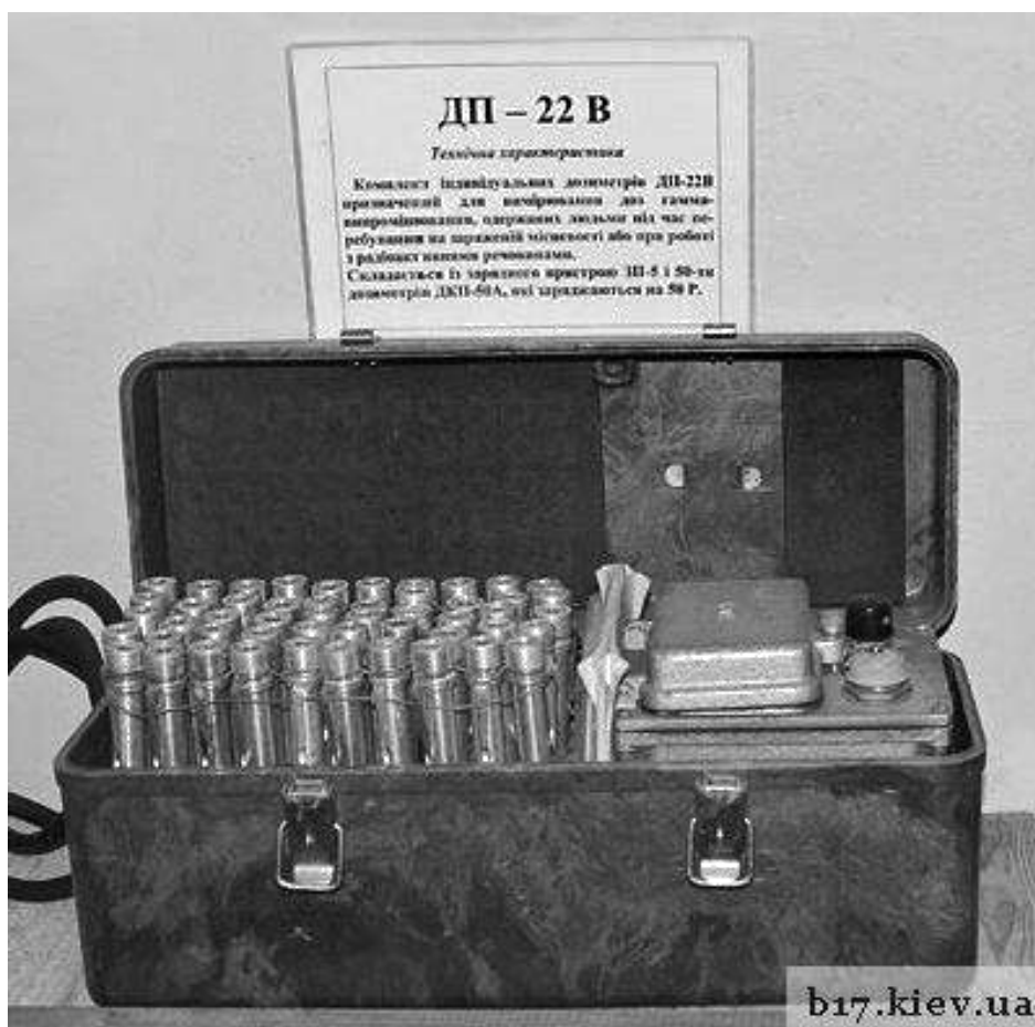
Рис. 5.16. Комплект індивідуальних дозиметрів ДП-22В:
