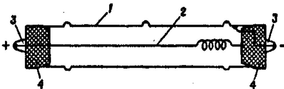
Мал.22. Газорозрядний лічильник з металевим корпусом 1 – корпус лічильника (катод); 2 – нитка лічильника (анод); 3 – виводи; 4 - ізолятори
