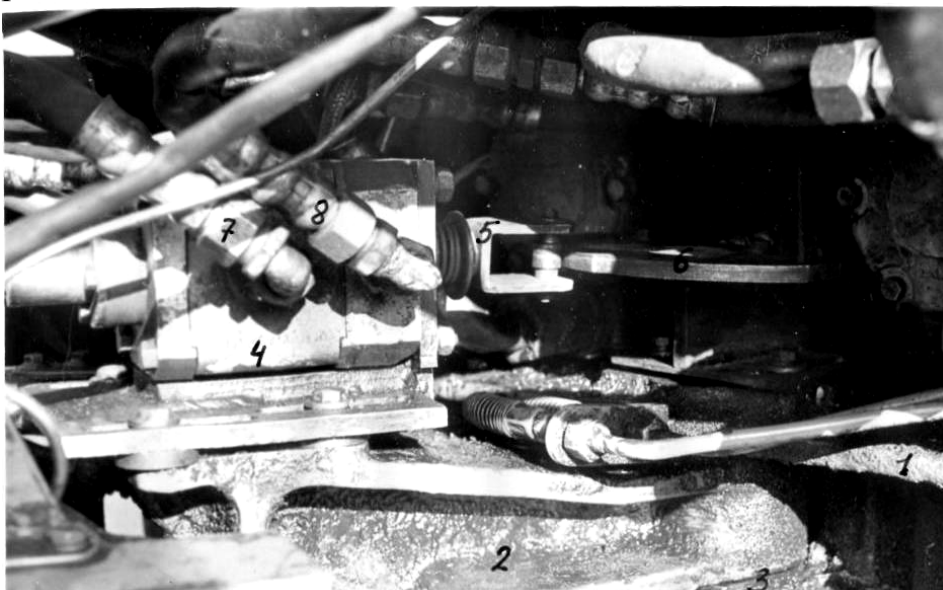
Рис. 3. Установка гідростабілізатора повороту на тракторі Т 150К.
